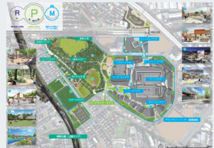
14か所の広場、円環状の回遊動線が民地（青）、官民融合敷地（黄緑）、公有地（緑）の境界を超え、一体的に再整備された。これらが「すべてが公園のようなまち」の骨格になっている
